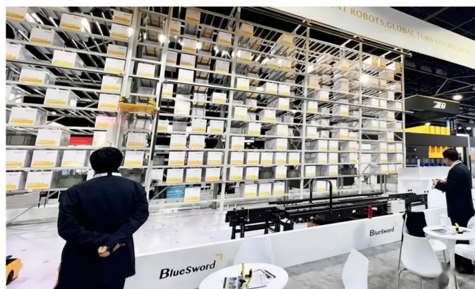
图表57：兰剑智能壁虎料箱机器人系统优化货到人拣选
