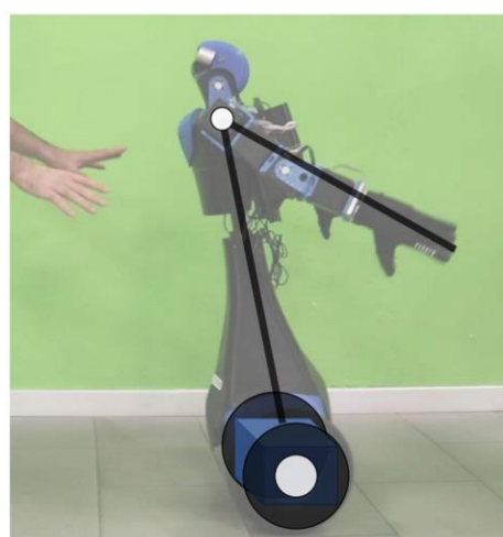
图表19：双轮类人机器人可以简化为两轮倒立摆运动学模型
