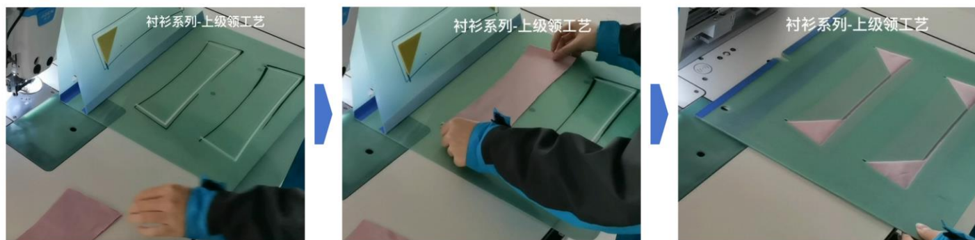
图表34：模板机自动化程度更高，但上下料还是需要人工操作
