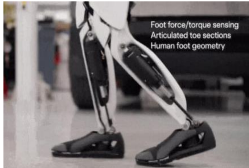
圖 Optimus足部採用六維力傳感器維持身體平衡
