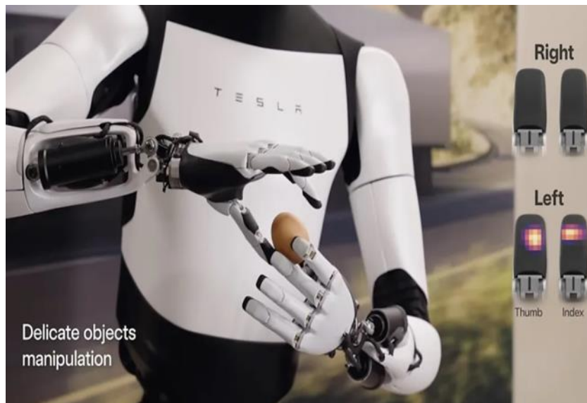
圖 特斯拉Optimus需配置觸覺傳感器實現靈巧抓握
