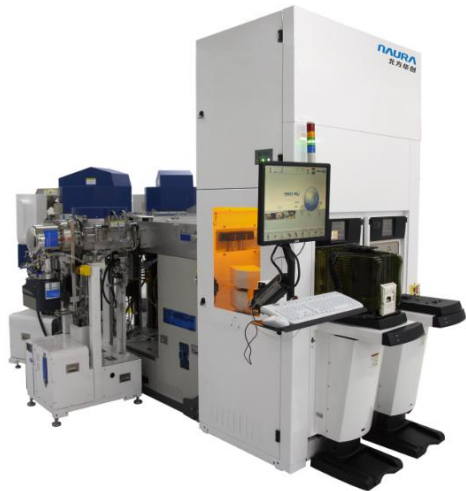
北方华创Polaris Series 硅通孔物理气相沉积系统
