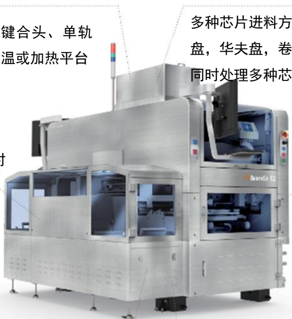
华封科技最新一代高精度贴片机 AvantGo E2
