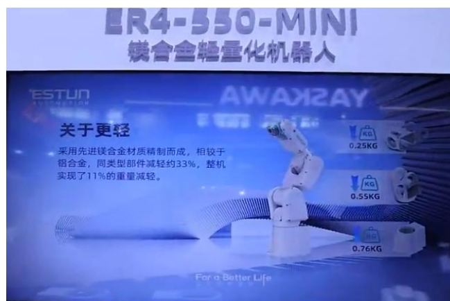
图13：埃斯顿镁合金机器人整机实现 11%的重量减轻
