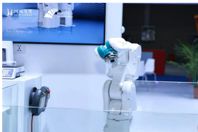
图12：ER4-550-MI 镁合金工业机器人
