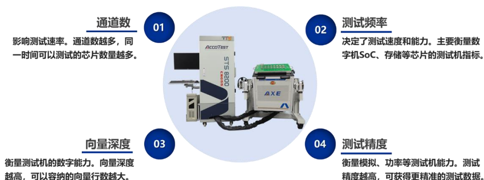
图 15：测试机的核心参数指标
