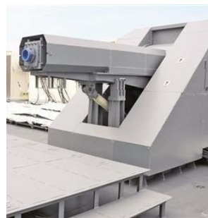
图表：日本“飞鸟”号试验舰的电磁轨道炮原型系统
