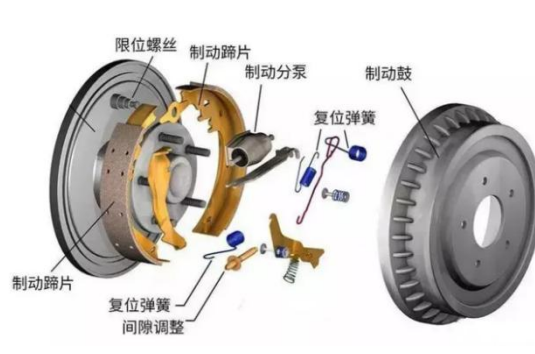
图8：鼓式制动器结构
