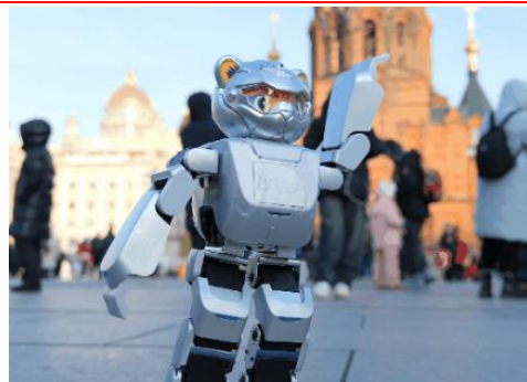
图 16：“铝镁侠 III”胸前盖板材料系由铝镁合金废料重铸而成
