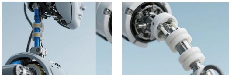
图 17：颈部和关节用到 PEEK 及其改性材料
