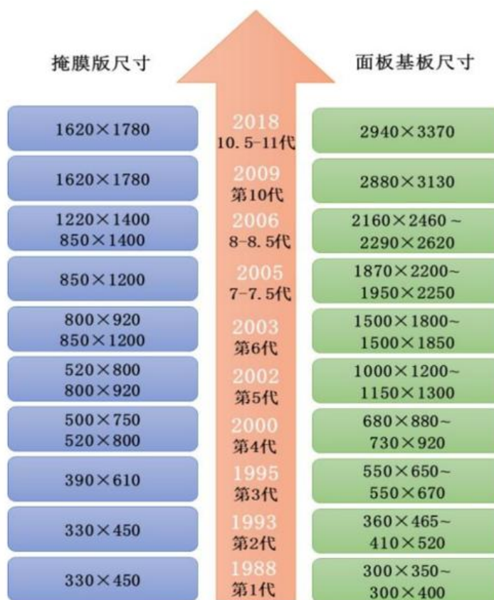
图 15：掩膜版型号与面板基板尺寸同步迭代（单位：毫米）
