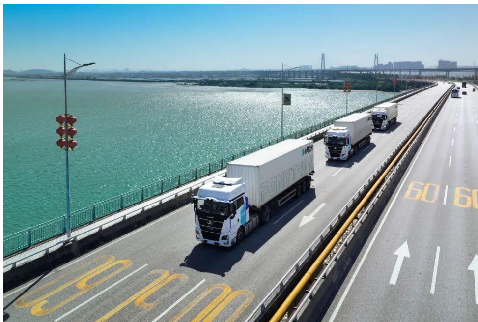
图9: 小马智行 Robotruck 采用“1+N”编队自动驾驶
