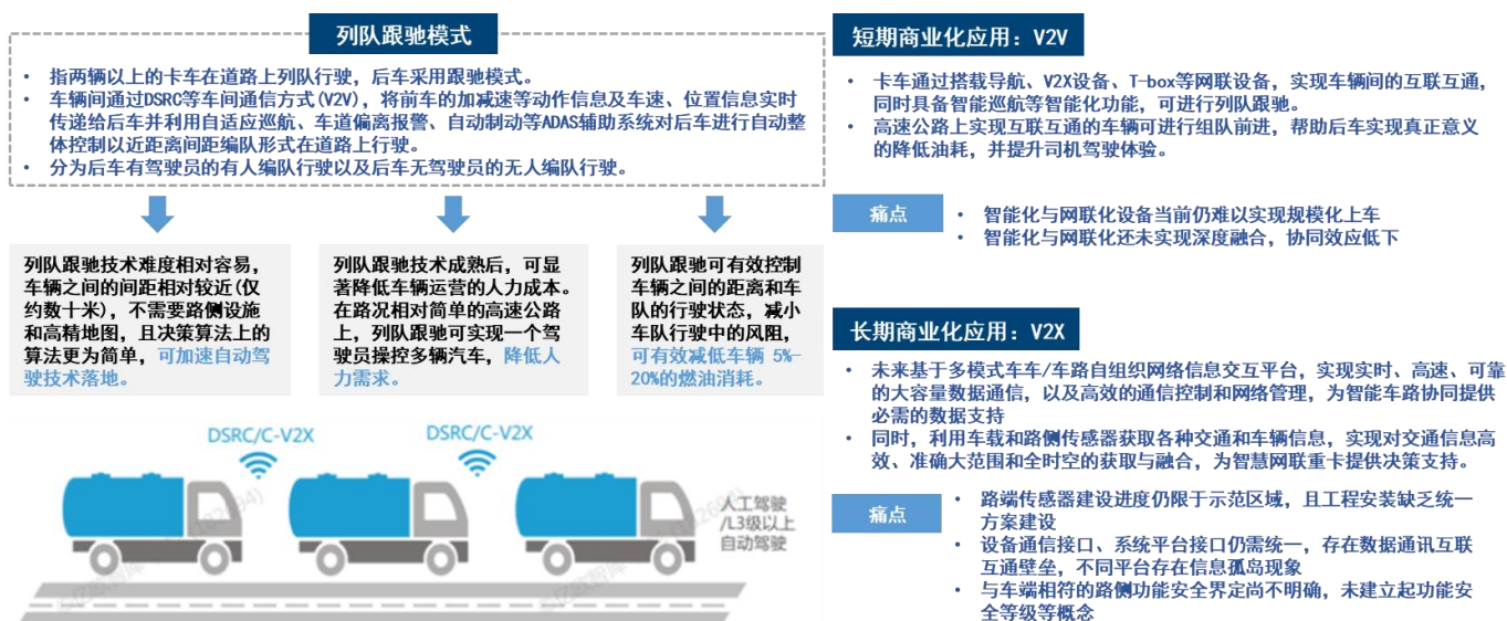
图39：Robotruck 列队跟驰模式（编队行驶模式）
