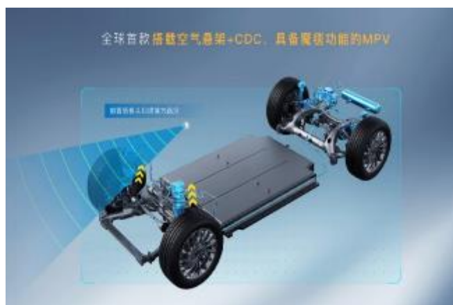
图 25：岚图空气悬架、CDC 示意图
