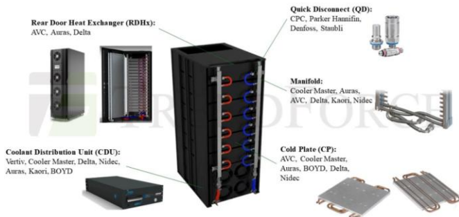
图15： GB200 NVL72 液冷机柜
