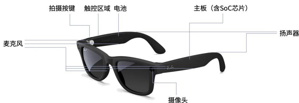
图 33：AI眼镜典型架构（以Ray-Ban Meta为例）
