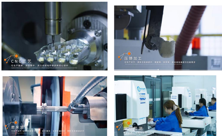
图 2：领益智造针对机器人零部件的 CNC 工艺、压铸加工、磨床加工、外观检测
