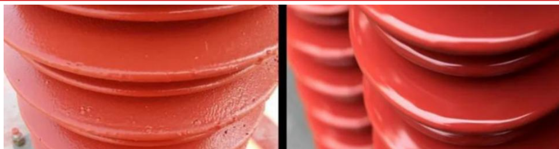
图31：绝缘子喷涂、浸涂产品差异
