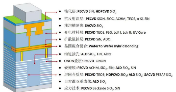
图表 15 薄膜沉积设备在 3D NAND 存储芯片中的主要应用
