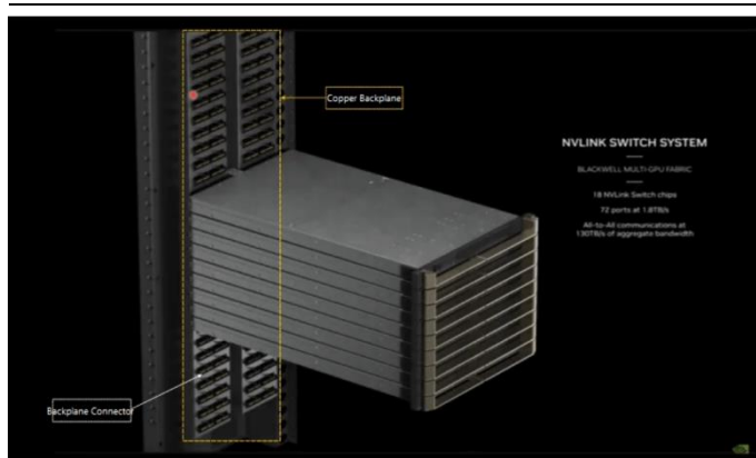
图14: NVIDIA GB200 NVL72 铜缆背板和背板连接器示意图
