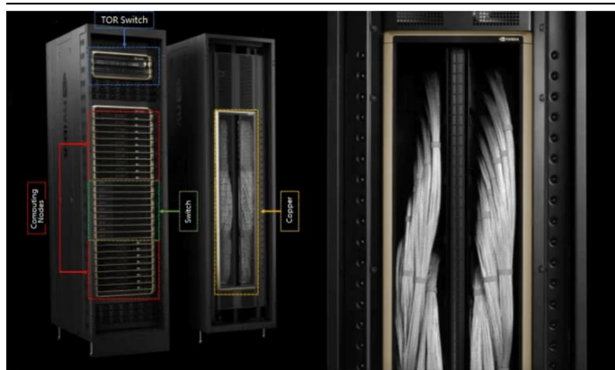
图13: NVIDIA GB200 NVL72 单机箱内部的交换机和计算节点连接示意图
