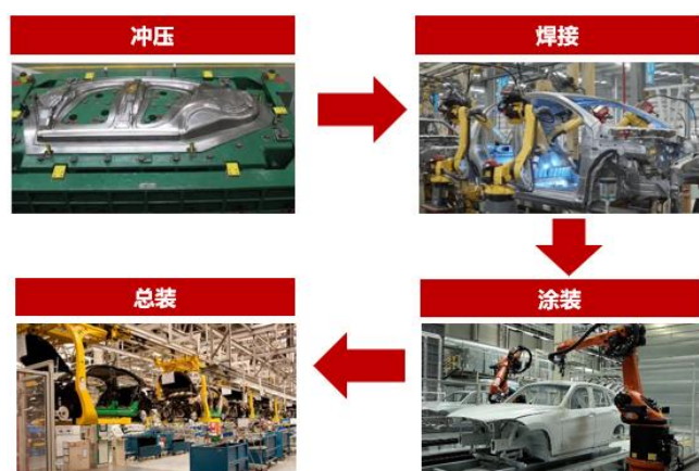
图11：汽车制造主要工艺流程图
