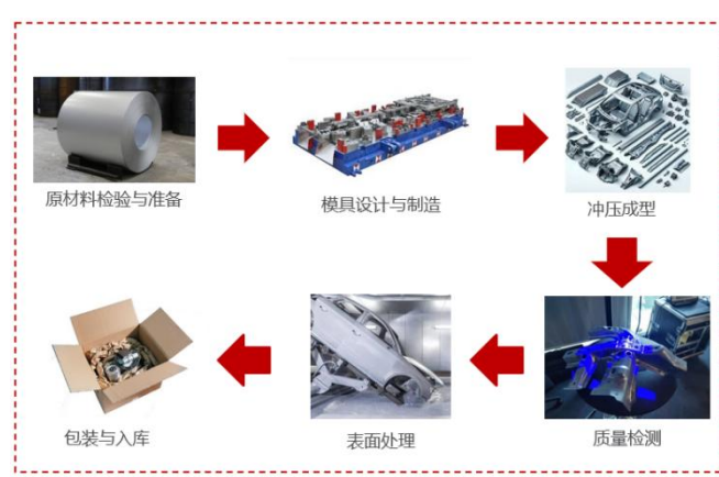
图12：汽车冲压工艺流程
