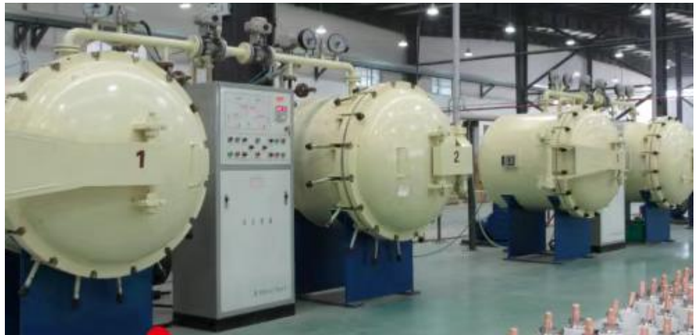
图13: 旭光电子真空器件加压检漏设备
