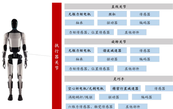
图 34：人形机器人执行器关节示意图
