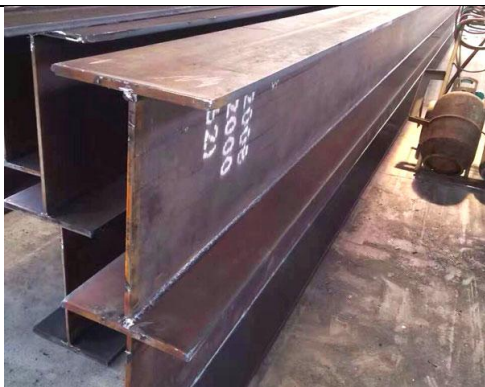
图 8：主焊缝焊接完成之后成品图
