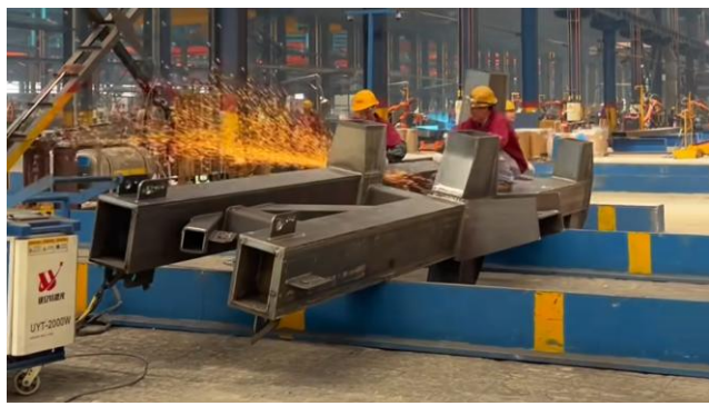
图 12: 传统人工焊接实景图
