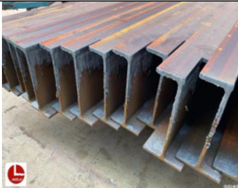
图 18: 喷涂前钢结构表面图
