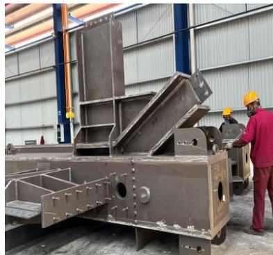
图 11: 钢结构构件由多种零部件拼接组成
