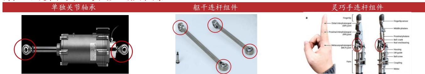
图表 54：关节轴承在人形机器人的应用场景
