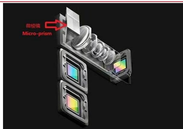
图表 39：微棱镜在潜望式摄像头的应用示意图
