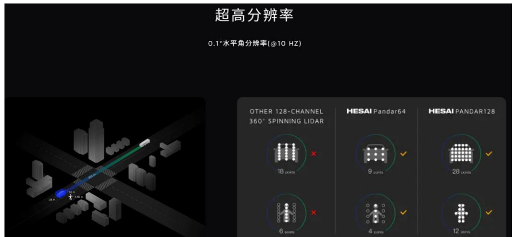
图21：公司推出 PANDAR 128 线远距激光雷达做到更高分辨率且点云更加清晰
