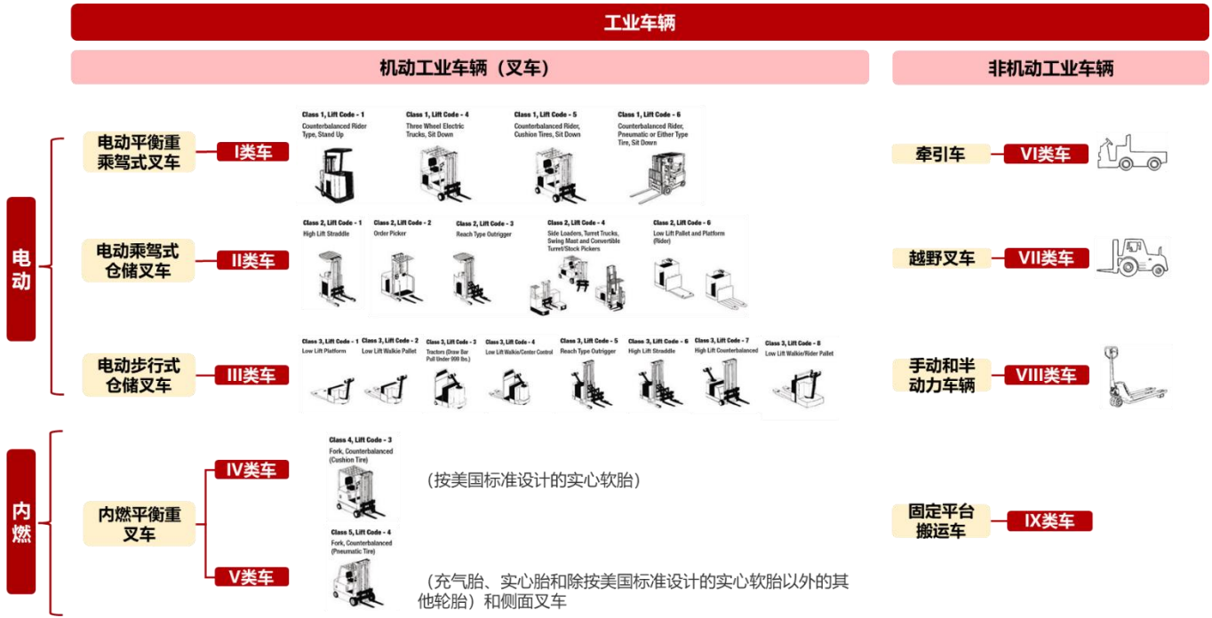
图15：工业车辆分类：主要包括机动工业车辆（叉车）（I-V型）与非机动工业车辆（VI-IX型）
