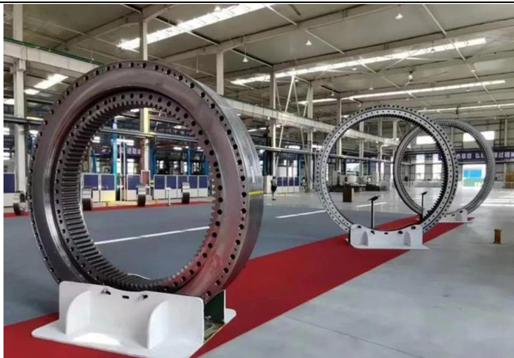
图 39：由中信特钢提供材料的国内首套 16 兆瓦平台风电主轴承下线
