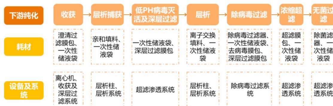
图 9：生物药分离纯化流程示意图
