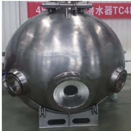
图 28：钛合金耐压舱示意图
