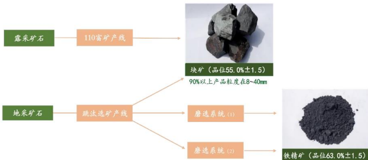
图9：海南矿业铁矿石产品生产流程图
