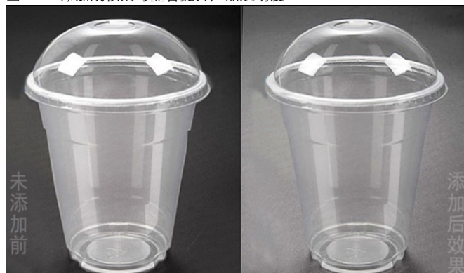
图 15：添加成核剂可显著提升产品透明度
