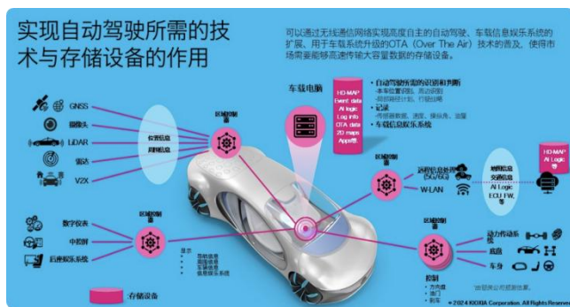
图 25：实现自动驾驶所需的技术与存储设备的作用
