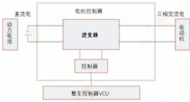
图13: 逆变器的工作原理
