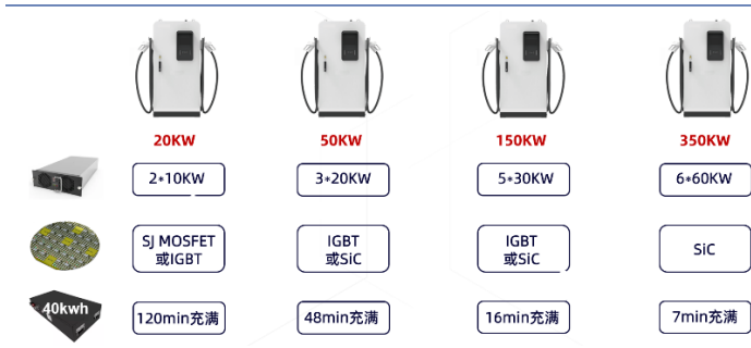
图24：直流充电桩功率器件演进趋势
