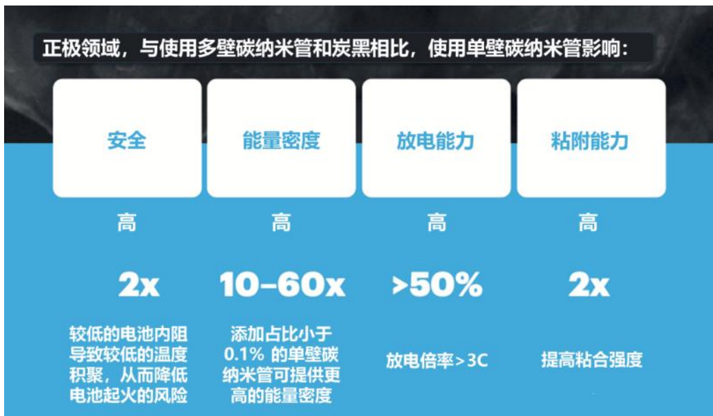
图 31: 单壁碳纳米管在电池正极中的工作原理
