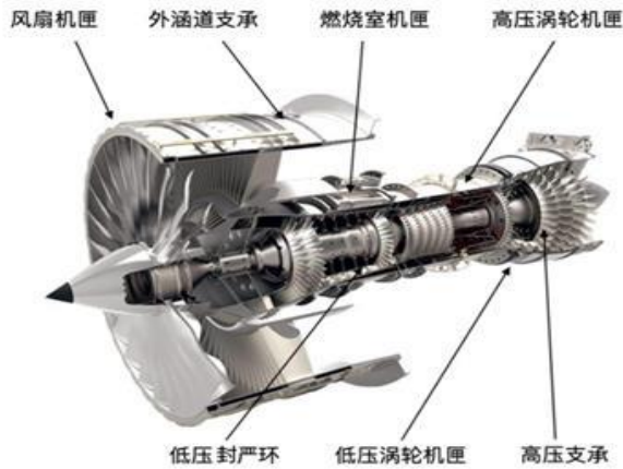
图16: 环形锻件为航空发动机结构的重要组成部分之一
