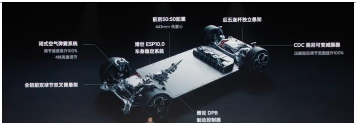
图32: 公司底盘系统采用了闭式空气弹簧+CDC 阻尼可变减震器、全铝前双球节双叉臂悬架+后连杆独立五悬架等高端配置
