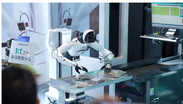
图表10：精灵 G1x 德马科技可自主高效分拣包裹
