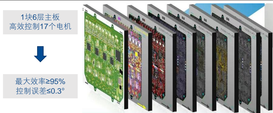
图49、兆威灵巧手通过单芯片控制多台电机
