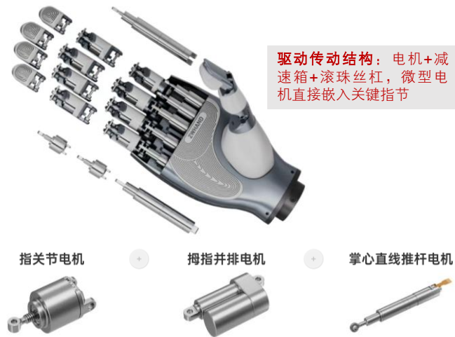
图46、兆威 DM17 灵巧手传动驱动结构
