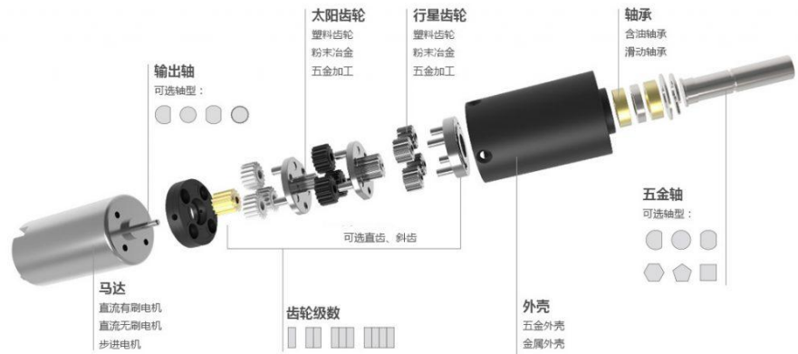
图43、兆威机电三级行星减速器结构
