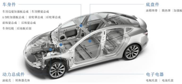
图2: 公司冲压零部件: 车身体件、底盘件、动力总成件及电子电器
