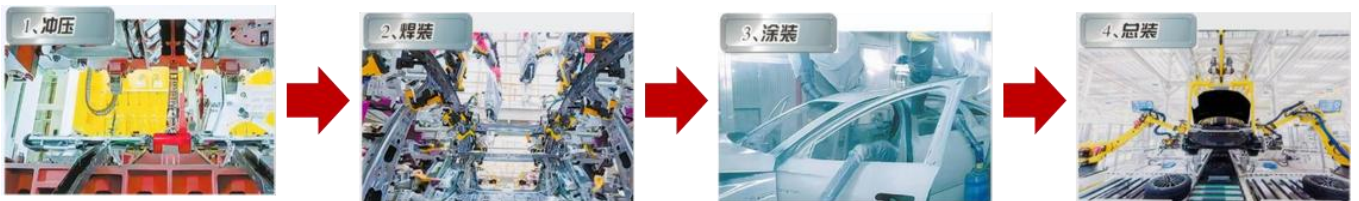
图16: 汽车制造四大工艺: 冲压、焊接、涂装、总装
