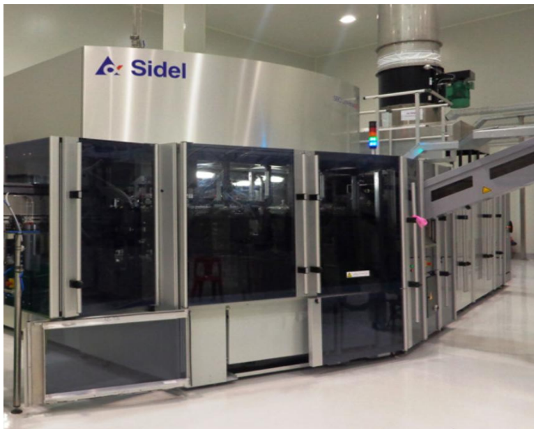
图表：西德乐为General Beverage设计的整线无菌生产线
