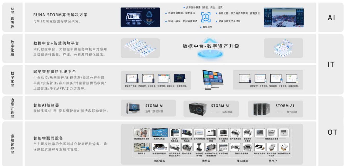
图11：城市热力系统实现“感-边-数-智-云”五层协同，构建从底层感知到顶层智能的系统解决方案
