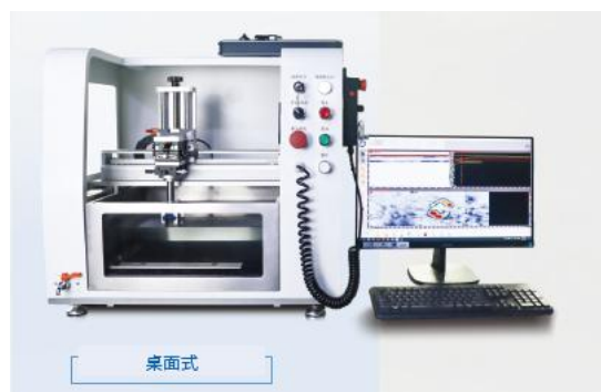
图 30：水冷板相控阵超声设备，最轻的小型水槽重 300 公斤
