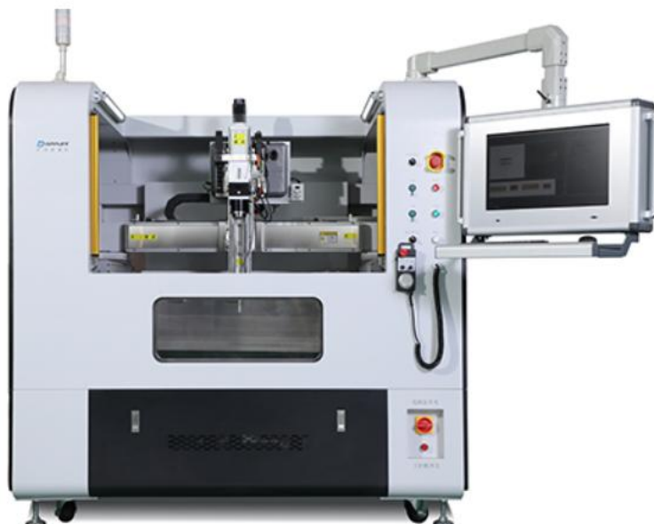
图 59：搅拌摩擦焊相控阵检测系统
