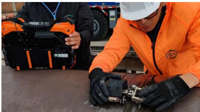
图 17：焊缝超声相控阵检测
