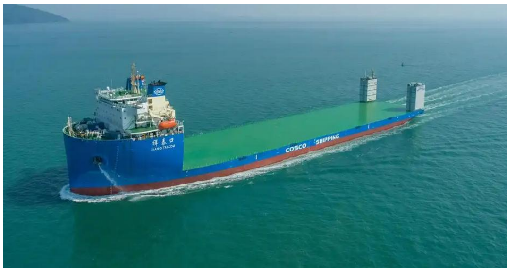
图表 35：船体可通过压载水下沉，以方便设备装卸、运输与安装
