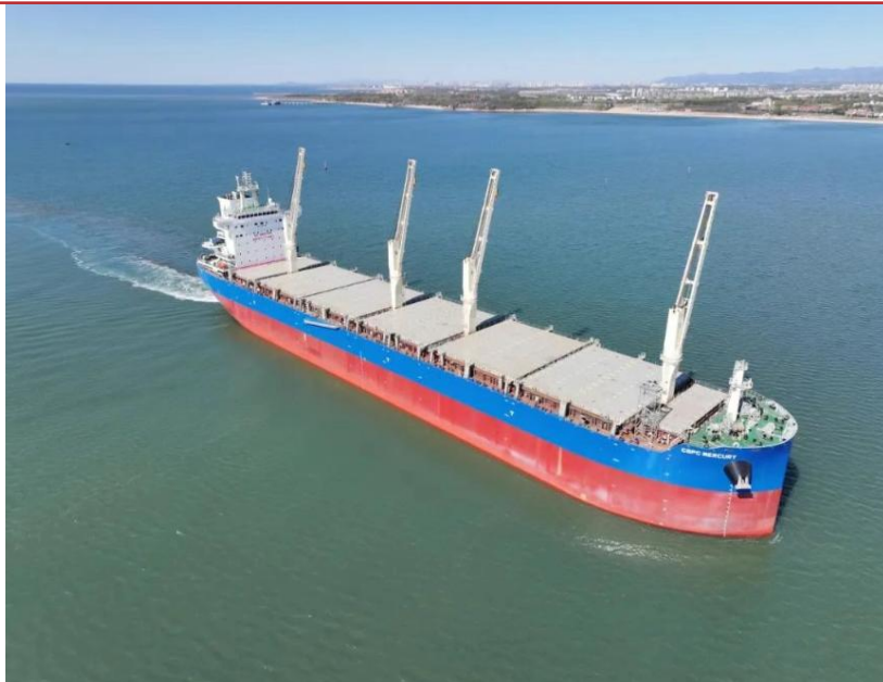
图表 14：多用途船一般都配有船吊，具有自装卸能力
