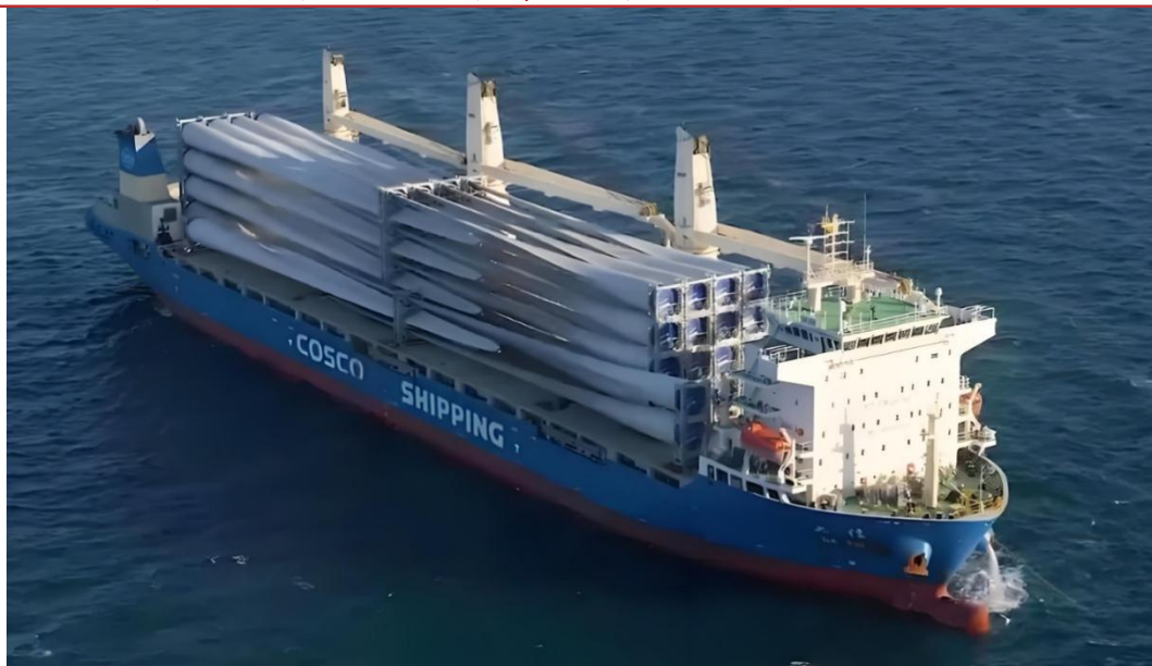
图表 15：重吊船配有起吊能力更强的吊机，可装卸重量更大的货物
