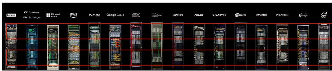
图 8: 目前大部分 NVL72 机柜内部放 48 个 PSU,8 组 power shelf
