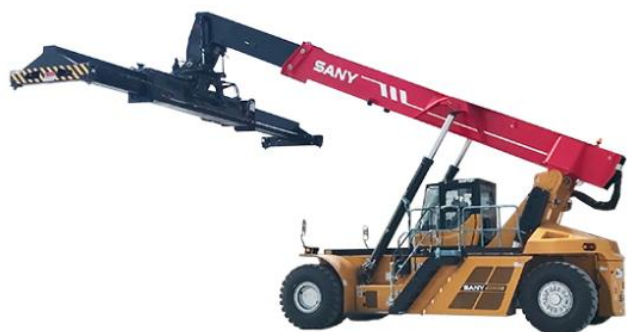
图40：小港机之正面吊
