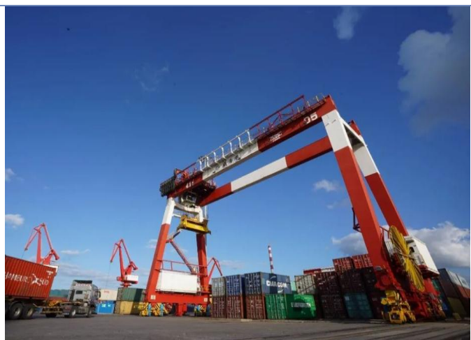
图38：大港机之场桥（轨道式集装箱门式起重机）
