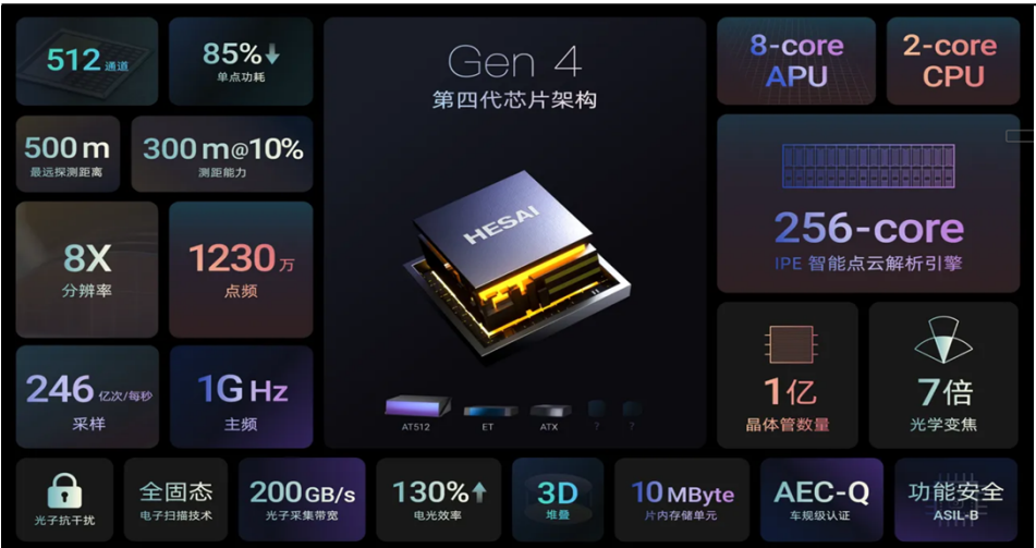
图表 85：禾赛科技第四代芯片架构
