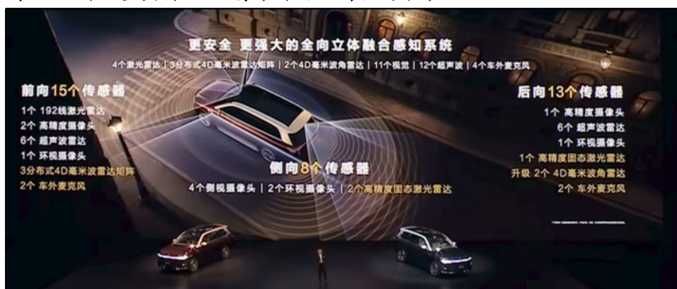
图表 13：2025 款问界 M9 升级至 4 台激光雷达（前向×1，侧向×2，后向×1），硬件配置具备 L3 级有条件自动驾驶的水平
