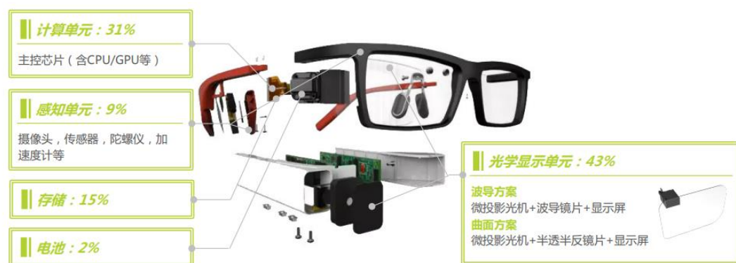
图表32：AR 整机设备模块单元组成及 BOM 占比拆分
