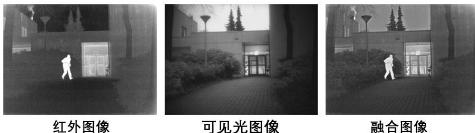
图表28：红外热像图能够呈现景物各部分的辐射起伏，从而显示出景物的特征
