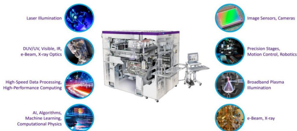
图表11: 量/检测设备核心技术设计光学、大数据、机器视觉、精确运动控制等技术
