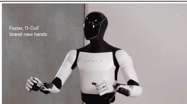
图1：特斯拉 Gen2 机器人单手配置 11 个自由度
