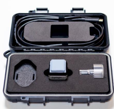
图11：GelSight 视触觉传感器具有易集成特点，适用于多种机器人平台和操作系统
