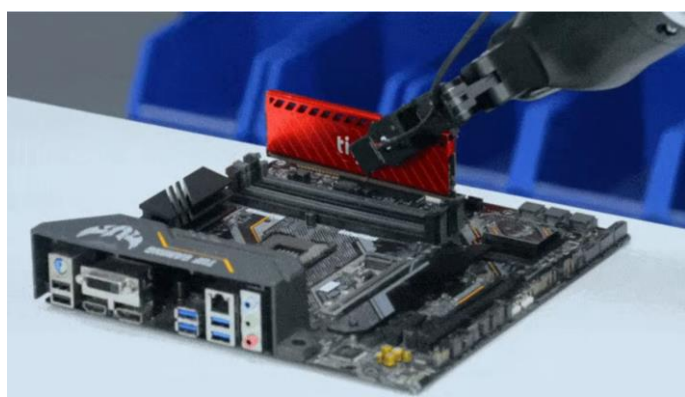
图28：千觉 G1-WS 传感器为智元机器人提供神经纤维般灵敏的末端触觉
