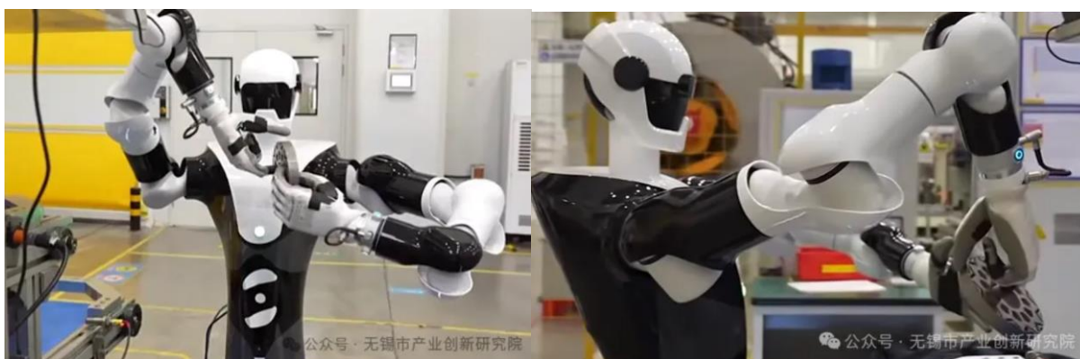
图16：公司自研的灵巧手已用于完成转子加工产线工作
