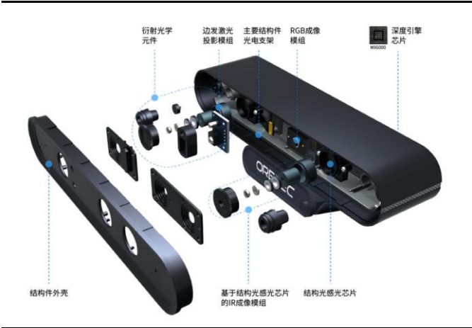
图16：3D 视觉传感器内部结构
