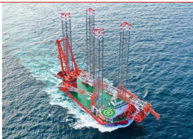
图表 20：由黄埔文冲建造的新一代 2000 吨自升自航式海上风电安装平台“白鹤滩”号
