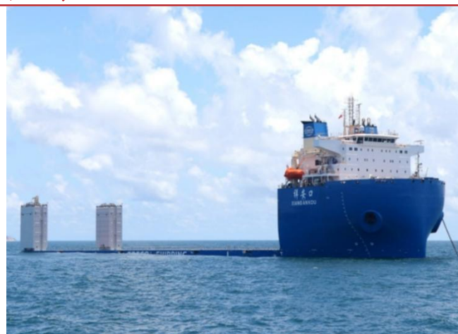
图表 21：由广船国际建造的 5 万吨智能半潜运输船“祥安口”号
