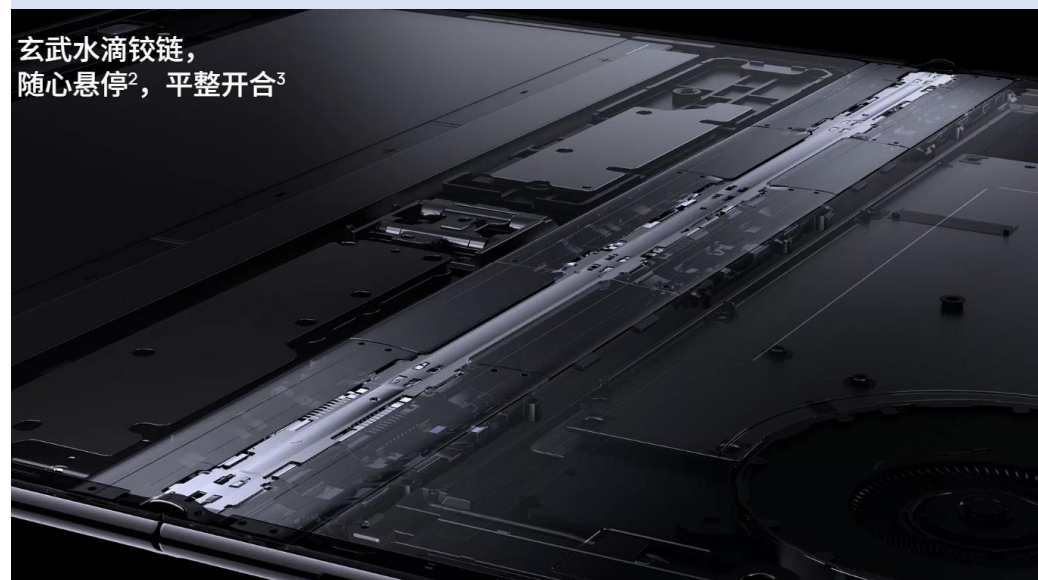
图：华为折叠电脑转轴使用锆基液态金属
