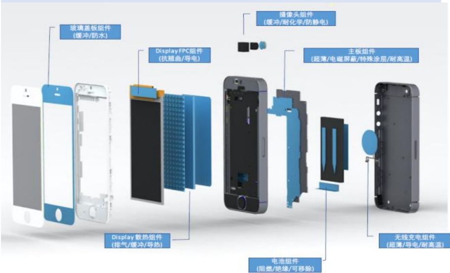
图：电子复合功能材料在智能手机中的应用
